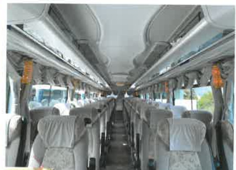
左右別の色で織ることで2名掛けシートを独り占めしないように工夫されている(三重交通)
