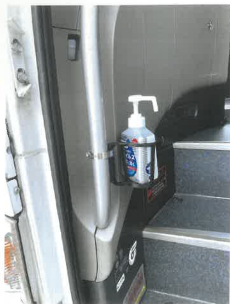
ガイドなどが、ドアの前で消毒液を持って待っている手を省く、消毒ボトルホルダー
